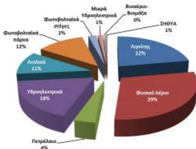
Σχήμα 2.2: Σύνολο εγκατεστημένης ισχύος (Ιανουάριος 2016)
