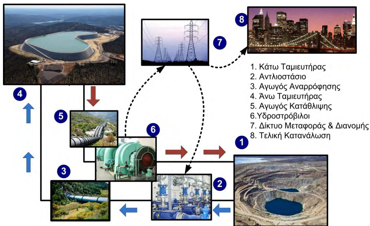
Σχήμα 4.12. Τυπική διάταξη σταθμού αντλησιοταμίευσης.
